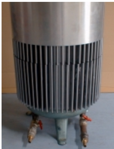
Fig. 4.3. Foto af nederste del af beholder. Kappen er løftet op, så man kan se konvektorfinnerne mellem beholder og kappe.
