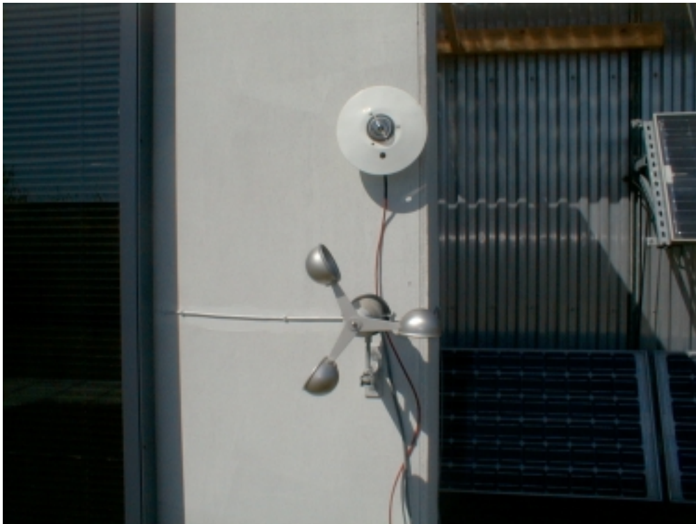
Figur 4.7. Måling af totalt solindfald på solskodden samt vindhastighed foran solskodden.
